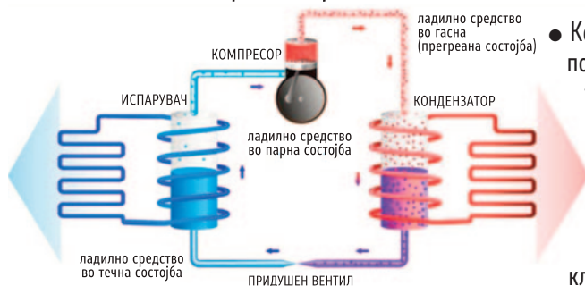
ТОПЛИНСКА ПУМПА ВОЗДУХ-ВОДА принцип на работа
